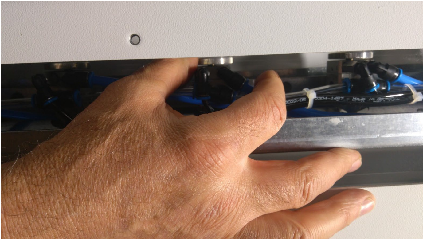
Manuelle DüsenEinstellung über Rändelrad
