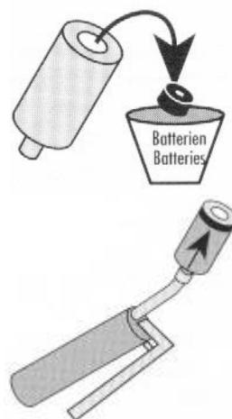
2) Schroef de navulnippel nr. 3012 op de simalube en vul deze met behulp van een handvetspuit tot de zuiger geheel naar achteren is geschoven. Geen druk opbouwen, noch lucht inpompen. Na vulling met olie in elk geval de uitgang met een stop of het terugslagklepje afsluiten.
