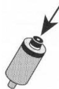
Visser la nouvelle tête de commande (env. 2 NM) (s'assurer que l'anneau torique d'étanchéité est bien ajusté! / couple de démarrage ~ 2 Nm (17.7 lb.in.) avec une clé à bougies SW 21, sans poignée, bien serrer dans la main sans trop d'effort. Encliquer le couvercle. Avant de remettre le simalube en marche, observer les instructions "montage et mise en service" de la page 4.
