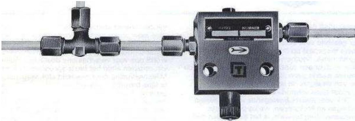
FRACTIONNEUR DE CADENCE HYDROMECHANIQUE sert à réduire la fréquence des impulsions de lubrification dans la ligne sur laquelle il est raccordé. L'appareil comprend un cylindre de commande hydraulique qui, sous l'effet d'une impulsion hydraulique, fait tourner un disque à orifices espacés de 30°. En fonction de la position et du nombre d'orifices, un orifice s'aligne avec la sortie de l'appareil et laisse passer l'impulsion hydraulique dans la ligne qui y est raccordée.
