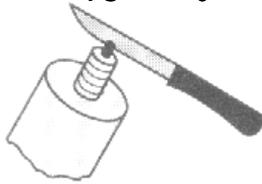
**Ne pas enlever le bouchon des graisseurs remplis d'huile!**
