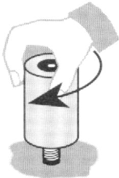
5) Vervang na afloop van de afgifteduur de *simalube* door eenzelfde type of vul de *simalube* na.
