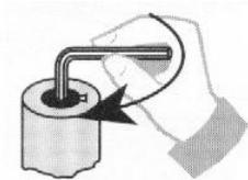
Régler la durée de distribution (en mois) sur la tête de commande à l'aide d'une clé à imbus (SW3). Lire la quantité de graisse désirée sur le diagramme en page 7.
