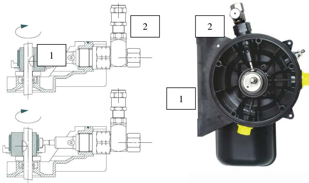
Jedes Pumpenelement hat ein einstellbares Druckbegrenzungsventil zum Schutz gegen Überdruck. Um das Fördervolumen zu fördern, können die drei Pumpenelemente zu einer Hauptleitung zusammengeführt werden.
