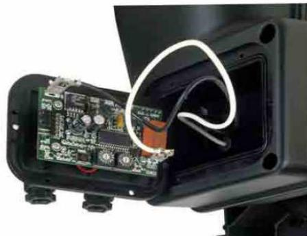
Der leuchtende Druckschalter kann an dem Steuergerät angeschlossen werden. Er kann für die Rückstellung, die Zwischenschmierung und die Fehlermeldung genutzt werden (schnell blinkend).
