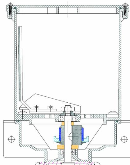
Der Zahnradmotor wird von einer IP-56 Schutzart Abdeckung (NYLON PA6) geschützt. Die Wasserundurchlässigkeit wird von O-Ringen gewährleistet. Die Pumpen können eine integrierte elektrische Impulsgeber- Kontrolle beinhalten. Dieser kann programmiert werden um die Pumpe automatisch mit variablen Betriebs- und Pausenzeiten arbeiten zu lassen.
