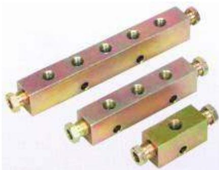
Les doseurs sont vissés dans des boîtes de distribution. Celles-ci sont disponibles en deux gammes: départs sur un côté et départs sur deux côtés, avec un nombre variable de sièges filetés (M 10 x 100) pour la fixation des doseurs ou des éléments de raccordement. Les extrémités des boîtes de distribution sont munies de raccords incluant bicone et écrou pour canalisation de 6 mm diamètre extérieur. Les départs non utilisés s'obturent au moyen d'un obturateur fileté.
